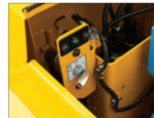
● 电控变速风扇，节省清洗散热器的时间
