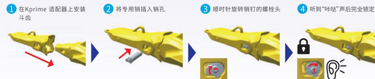
\*拆卸时，将棘轮逆时针旋转90度，推出销钉，然后发出“咔哒”一声完成。
